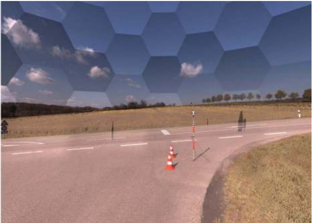
3D-Punktwolke aus der Geländeerfassung mit dem Laserscanner
